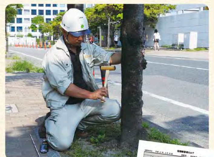
木槌で幹や枝を叩くなどして内部の状態を調べる。腐朽が進んでいる恐れがあると判断した場合は、機械を使い精密診断を行う。
